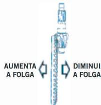
A área de contato acima - contato na extrema ponta da coroa. O contato extrema ponta da coroa, indica que a coroa está muito perto do pinhão, resultando em contato muito próximo da ponta do dente. Para corrigi-lo é necessário afastar a coroa do pinhão, aumentando a folga de engrenamento, para que a área de contato se desloque no sentido do centro do dente (ideal como na fig. 5)
