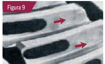
A área de contato acima - contato na extrema "talão" da coroa. O contato extrema "talão", indica que a coroa está muito afastada do pinhão, resultando em contato muito próximo do talão do dente ("Heel"). Para corrigi-lo é necessário aproximar a coroa do pinhão, diminuindo a folga de engrenamento, para que a área de contato se desloque no sentido do centro do dente (ideal como na fig. 5)
